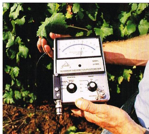
Датчик, покрытый листом сорта Cabernet Franc для измерения только трансмиссии света, показывает ФАР, равный 60 \mu\text{E m}^{-2}\text{s}^{-1} . Трансмиссия составляет 5,5 %. (Фото Б.У.)
