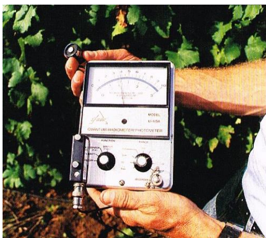
ФАР-датчик в полной экспозиции к солнцу показывает 1100 \mu\text{E m}^{-2}\text{s}^{-1} . (Фото Б.У.)
